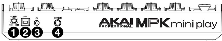
1. **Interrupteur d'alimentation** : Cet interrupteur doit être réglé selon le mode d'alimentation sélectionné, soit par connexion USB (USB) ou par piles (BATT). Lorsqu'il est réglé sur USB et qu'aucun câble n'est connecté, le MPK mini Play mk3 sera automatiquement mis hors tension afin de prolonger la durée de vie des piles.
